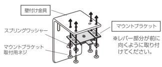
※マウントブラケットのネジ穴は6つあり、両端4ヶ所のネジ穴で、壁付け金具(別売り)に固定します。
