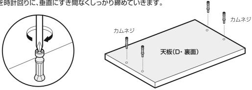
⑧ 手順⑥で固定した柱板(E)の内側からカムロックをセットします。
