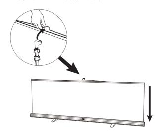
④ ゴムフックを掛け、脚を90度回転させて 収納します。
